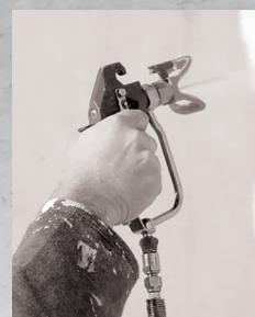
La pulvérisation se fait à l'aide d'une machine sans air. La machine est équipée d'un pistolet et permet une dépose régulière, une rapidité d'exécution et de mise en œuvre sur les chantiers. Le confort d'utilisation est un des grands avantages de l'airless : légèreté du pistolet et du tuyau, moins bruyante, plus maniable et avec un encombrement réduit. C'est la machine la mieux adaptée aux chantiers à étages.
