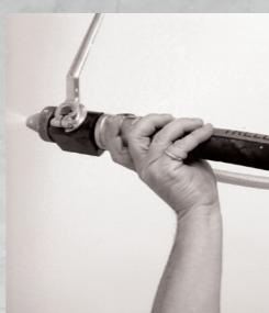
La projection se fait à l'aide d'une machine qui utilise une source d'air. A l'aide d'une lance, la machine permet une dépose régulière du produit avec un réglage air sur la machine. Les enduits à projeter sont utilisés pour des chantiers de moyenne et grande taille. L'encombrement et le poids sont une limite de la machine sur les chantiers à étages.
