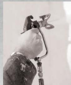
La pulvérisation se fait à l'aide d'une machine sans air. La machine est équipée d'un pistolet et permet une dépose régulière, une rapidité d'exécution et de mise en œuvre sur les chantiers. Le confort d'utilisation est un des grands avantages de l'airless : légèreté du pistolet et du tuyau, moins bruyante, plus maniable et avec un encombrement réduit. C'est la machine la mieux adaptée aux chantiers à étages.
